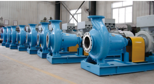
160KW大型磁力泵生产现场
