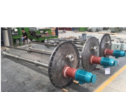
4.2米液下磁力泵生产现场
